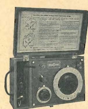
Ponte per misura capacità tipo 1614-A
